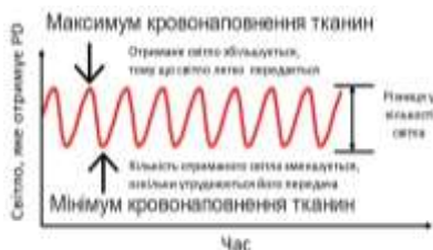
Рис. 8. Графік зміни поглинання світла в умовах зростання та зменшення тканинного наповнення кров'ю (під час спазму та розширення судин)
