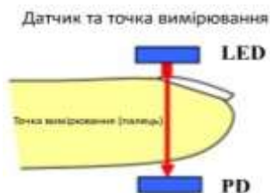
Рис. 7. Розташування на дистальній фаланзі пальця пульсоксиметричного датчика:
