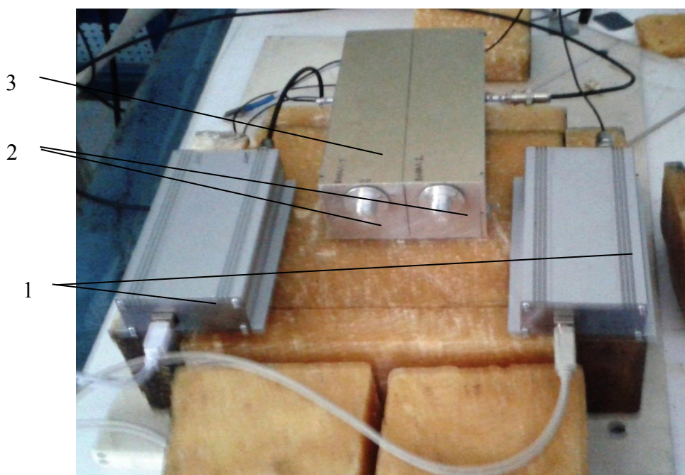
Рис. 3. Двухдетекторный модуль для регистрации тепловых нейтронов: 1 – аналогово-цифровые преобразователи, 2 – кремниевые детекторы Si-Gd и Si, 3 – спектрометрическая электроника Fig. 3. Two-detector module for recording thermal neutrons: 1 – analog-to-digital converters, 2 – silicon detectors Si-Gd and Si, 3 – spectrometric electronics
