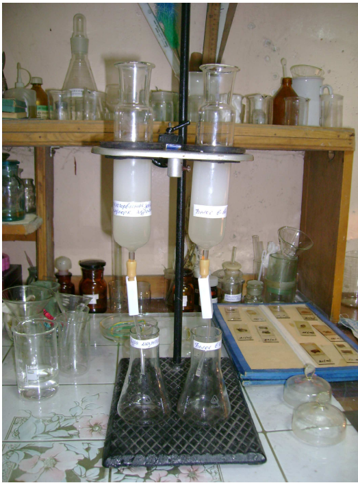
Рис. 2. Разделение фаз в делительной колонке для отделения нелипидных примесей.
