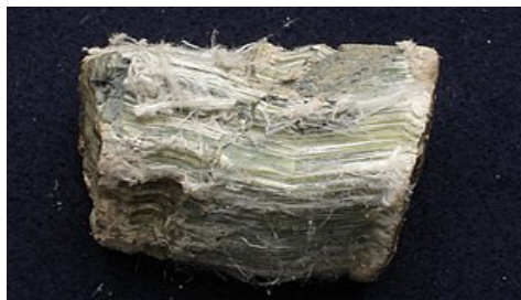
Рис. 2. Хризотил. М'який, волокнистий силікатний мінерал (філосілікат, група серпентин). Відрізняється від інших азбестоподібних мінералів групи амфіболів. Його ідеалізована хімічна формула – ідеалізована хімічна формула – Mg_3(Si_2O_5)(OH)_4
