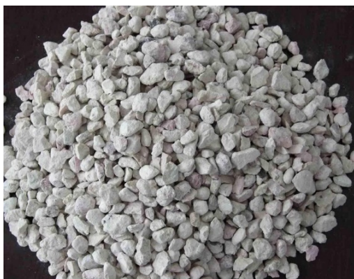
Рис. 7. Цеоліт природний. Різні гідратовані алюмосилікатні мінерали, водні алюмосилікати кальцію, натрію, калію, барію та низки інших елементів, відомі як мінеральний вид уже понад дві сотні років (з XVIII століття).
