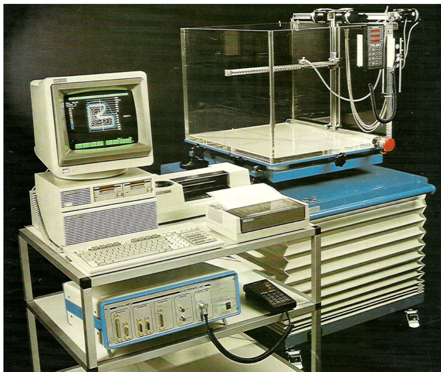
Рис. 21. Дозиметричний комплекс з водним фантомом
