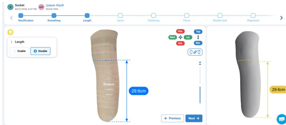
Рис. 2.8. Моделювання геометрії гільзи (Length Adjustment)
