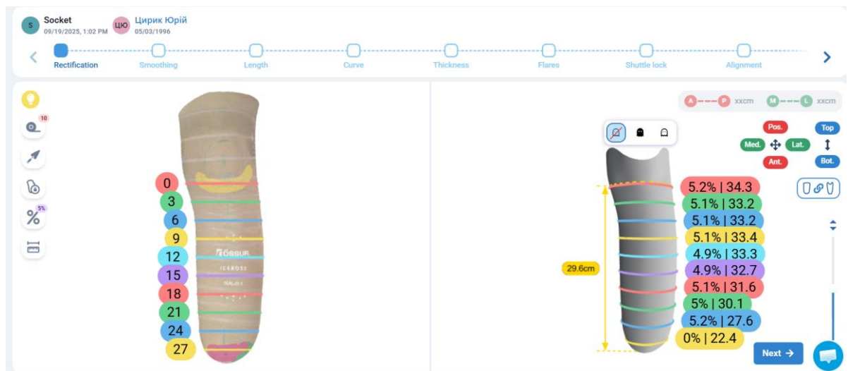
Рис.2.7. Створення анатомічної карти кукси (Anatomical Mapping)
