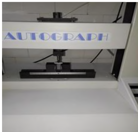
Рис. 2.2 Зовнішній вигляд пристрою AUTOGRAPH AGS-J для вимірювання міцності на вигін
