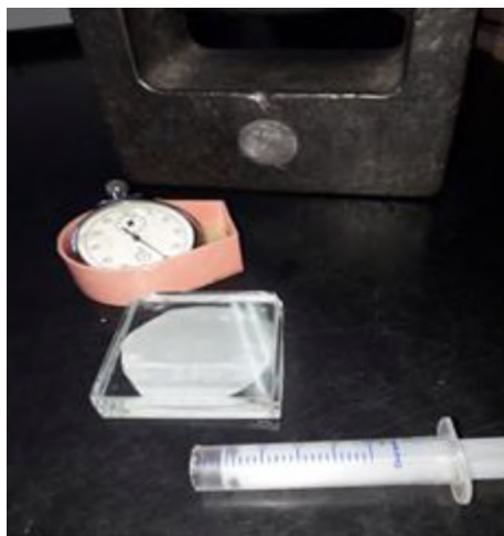
Рис. 2.11 Проведення випробування визначення товщини плівки
