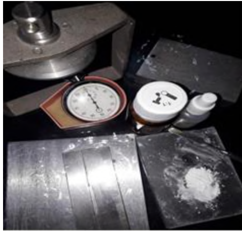
Рис. 2.1 Підготовка зразків для вимірювання міцності на вигін
