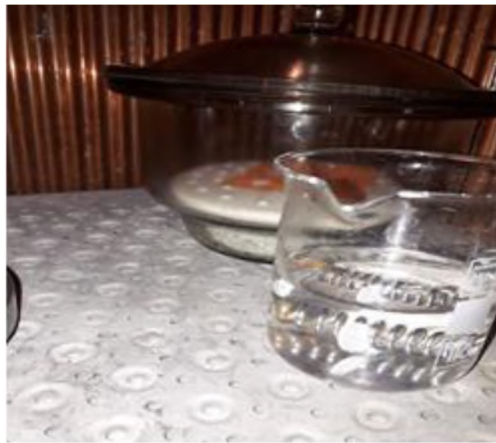
Рис. 2.4 Проведення випробування на водопоглинання
