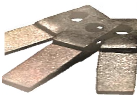
Рис. 2.13 Зразки нікель-хромового сплаву для випробування на зсув
