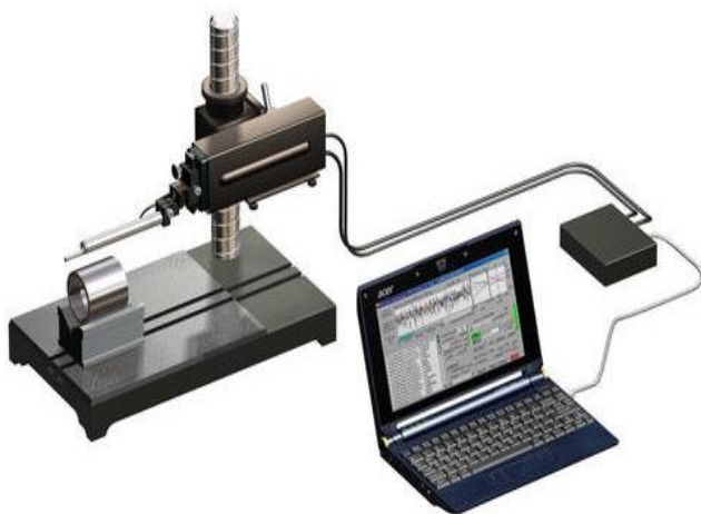
Рис. 2.3. Прилад «Профілограф-профілометр» 201 для випробування модифікованих зразків на показник шорсткості
