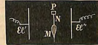
Рис. IX. NMP—нервно-мышечный препарат (на миографѣ), расположенный по одной прямой линіи между двумя электродами EI' и EI'' и параллельно имъ. Оба электрода установлены другъ противъ друга параллельно, на неравныхъ разстояніяхъ отъ NM—препарата.
