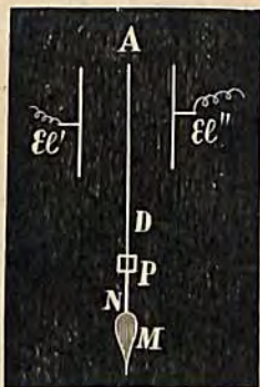
Рис. XI. Ee' и Ee'' —равные и параллельные между собою щитки-электроды AD —мѣдная прямая проволока проведенная посрединѣ между ними отъ P —позвоночника нервно-мышечнаго препарата NM (лежащаго на парафиновой пластинкѣ).
