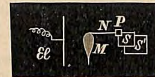
Рис. III — MN —нервно-мышечный препаратъ (на міографѣ).— P —кусокъ позвоночника при нервѣ; къ нему приложены станиолевья квадратикъ— S и S' — EI — Zn шитокъ-электродъ.
