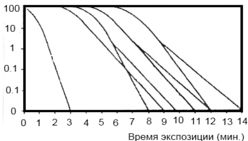
Рис.6. Инактивация озонем вирусов в речной воде по Snyder J.E. and Chang P.W., 1974 [100].
