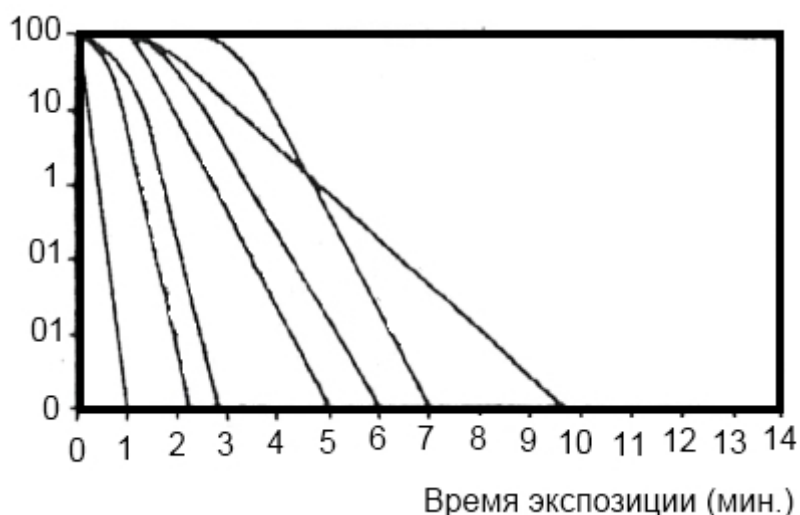
Рис. 7. Инактивация озонем вирусов в чистой воде Snyder J.E. and Chang P.W., 1974 [100].
