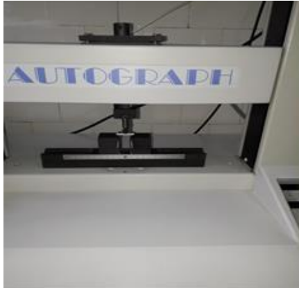
Рис. 2.4. Пристрій AUTOGRAPH AGS-J для вимірювання міцності на вигин
