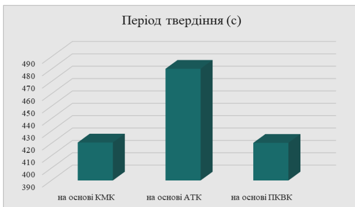
Рис. 2.20. Порівняння результатів часу остаточного твердіння СЦ для постійної фіксації незнімних конструкцій зубних протезів
