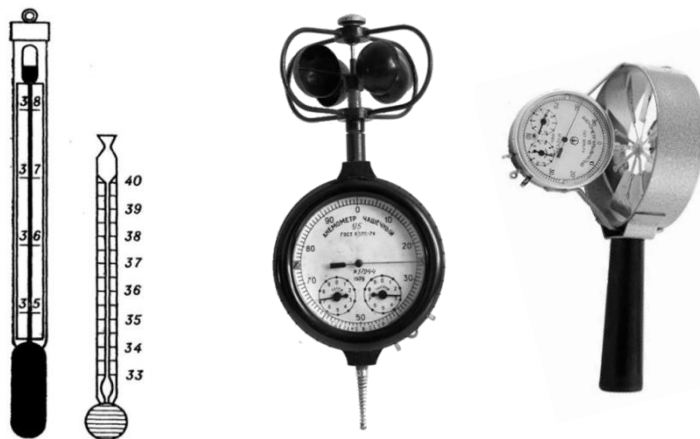
Рис. 4. Прилади для визначення швидкості руху повітря: кататермометр, чашечковий і крильчатий анемометри
