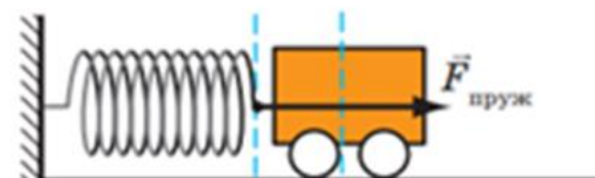
Пружина стиснута — сила пружності намагається розтягти пружину
