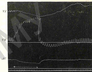
Од. 17. Вліаніе obturации нижней полой вены (+) на уровень диафрагмы на объемъ легкаго тонкаго кишечника (VJ), объемъ печени (VNI) и кровяное давленіе (AC).
