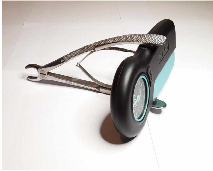
Рис. 2.3. Загальний вигляд виготовленого інструменту для моделювання перелому нижньої щелепи.
