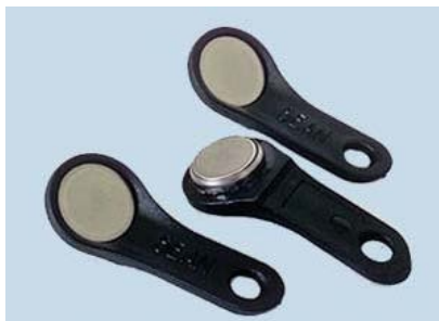
Рис.21.3. iButton – це сімейство мікроелектронних пристроїв, розроблених фірмою Dallas Semiconductor (USA)
