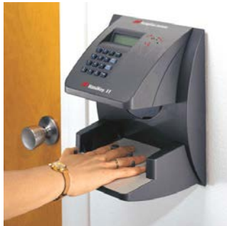
Рис. 21.5. Аутентифікація особи за допомогою біометричного зчитувача HandKey II
