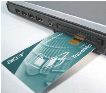
Рис. 21. 2 Контактні зчитувачі смарт-карт, що підключаються через порт USB (ліворуч) або в слот PCMCIA ноутбука (праворуч)
