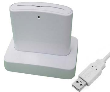
Рис. 21. 2 Контактні зчитувачі смарт-карт, що підключаються через порт USB (ліворуч) або в слот PCMCIA ноутбука (праворуч)
