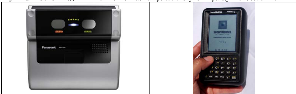
Рис. 21.6. Ручний (ліворуч) і стаціонарний (праворуч) сканери райдужної оболонки ока
