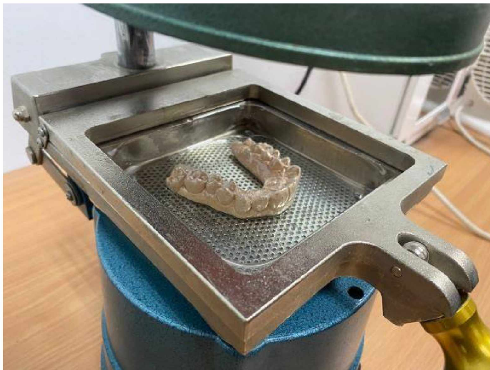
Рис. 2.8 Термопластична пластина, притиснута до поверхні робочої моделі верхньої щелепи
