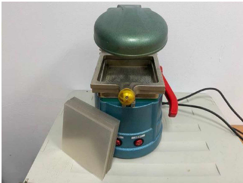
Рис. 2.7 Вакуумний формувач «Ultraform» та пластини термопластичного матеріалу «Джендентал» (Україна)
