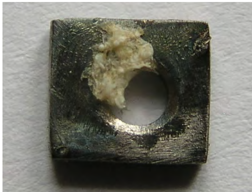
Рис. 10.14. Фрагмент кісткової тканини на субперіостальному імплантаті з кобальтохромового сплаву з вуглецевим алмазоподібним покриттям після випробувань на міцність зчеплення
