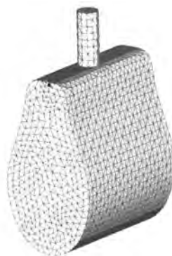
Рис. 11.1. Об'ємна скінченно-елементна модель фрагмента альвеолярного відростка щелепи з циліндричним ендоосальним імплантатом
