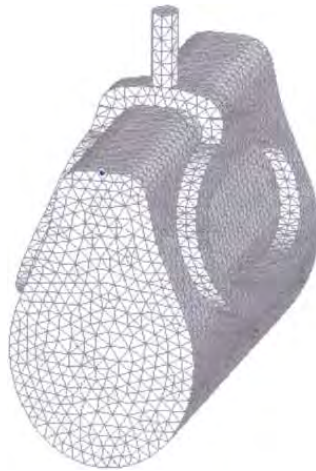
Рис. 11.7. Об'ємна скінченно-елементна модель фрагмента щелепи із субперіостальним імплантатом
