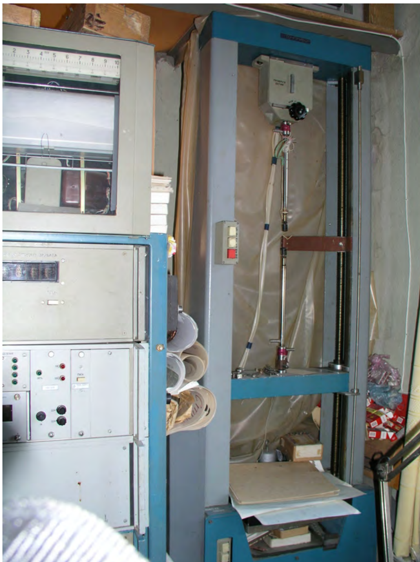
Рис. 10.4. Розривна машина 2038P005 для визначення сил зчеплення імплантатів із кістковою тканиною щелепи
