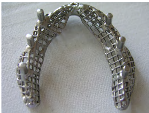
Рис. 13.83. Ливарна конструкція субперіостального імплантату перед остаточним обробленням і пасивацією
