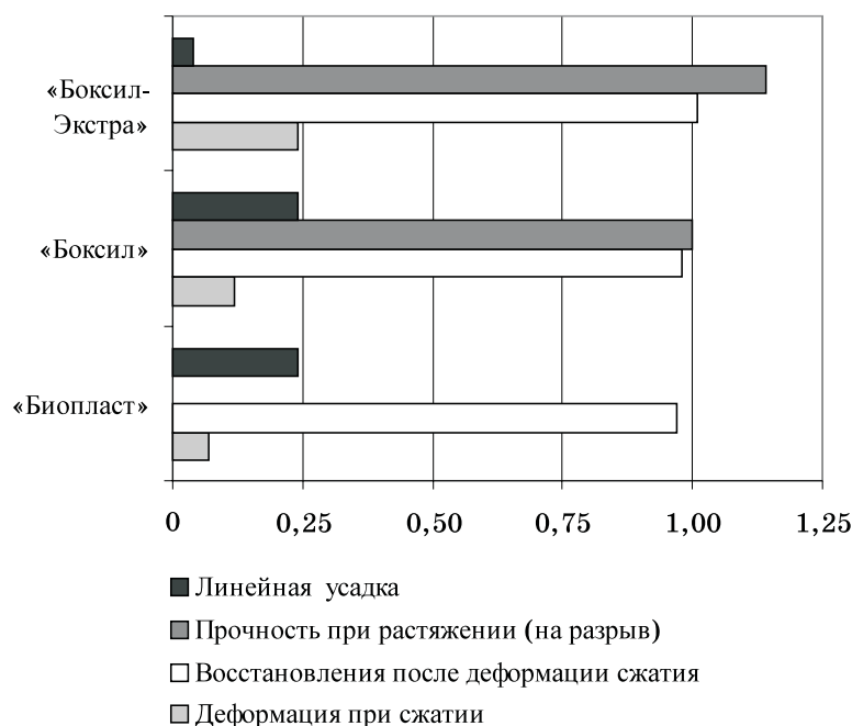
Рис. 1. Сравнительная характеристика физико-механических свойств материалов, применяемых для изготовления ИЗДП (стандартизованные показатели; ISQ=1,00)
