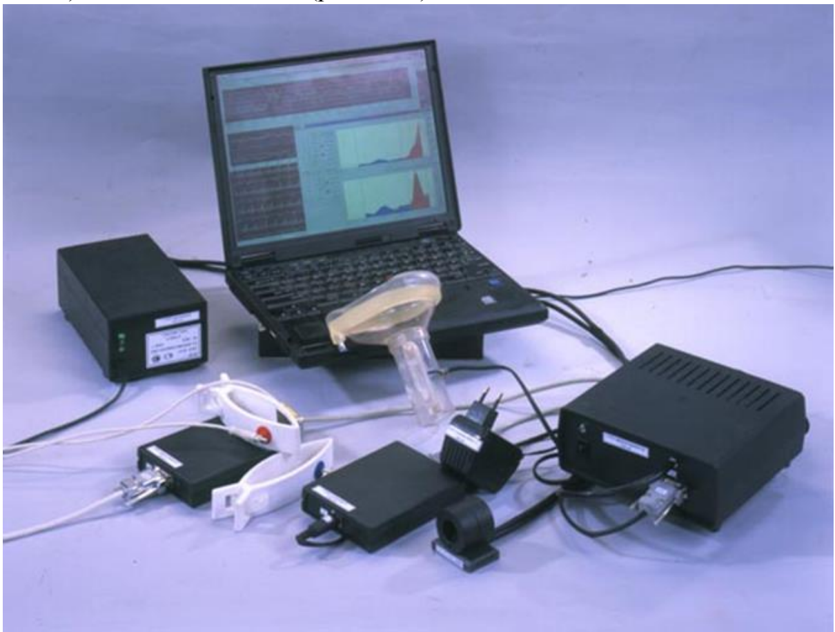
Рис. 2.3.1 Апарат для оцінки регуляторних особливостей кардіореспіраторної системи спіроартеріокардіоритмограф (САКР-2)
