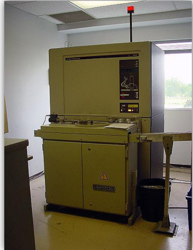
Рентгенівський флюоресцентний спектрометр з автоматичною подачею зразків у лабораторії контролю якості
