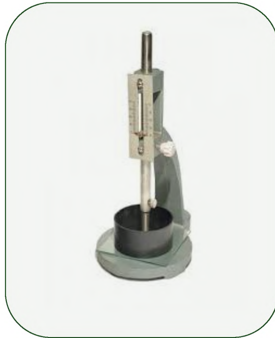
Рис.2.2 Прилад Віка ОГЦ для випробування модифікованих зразків на час схоплювання та затвердіння
