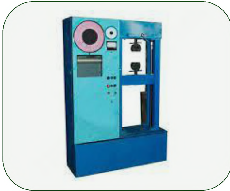
Рис. 2.1 Розривна машина 2161 P-5 для випробування модифікованих зразків на міцність при стисканні
