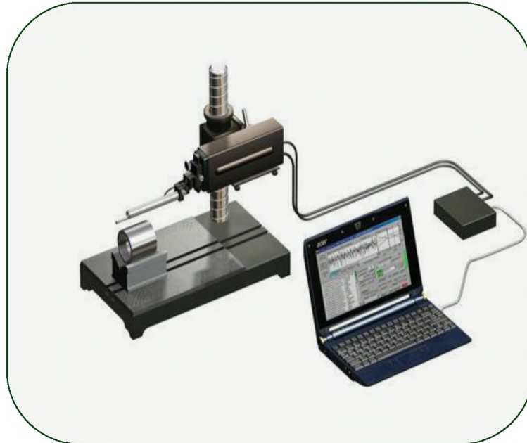
Рис. 2.3 Прилад «Профілограф-профілометр» 201 для випробування модифікованих зразків на показник шорсткості
