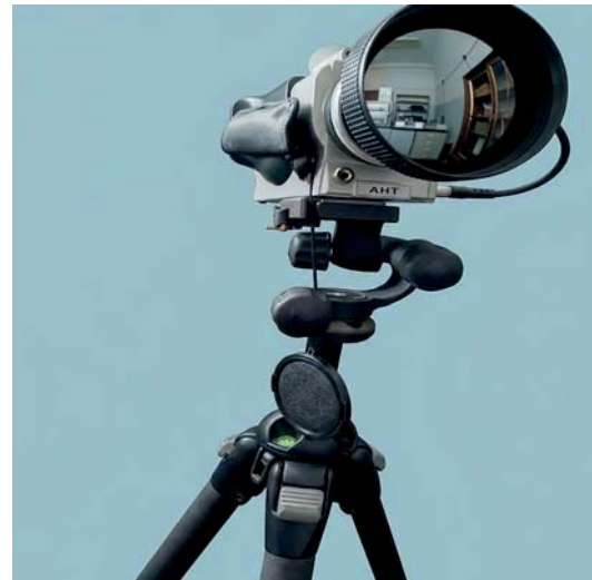
Рис.1. Диспергуючий ІЧ спектрометр з просторово-частотною роздільною здатністю.
