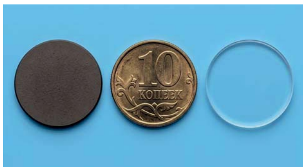
Рис. 3. Зразки монокристалів Al_2O_3 і TiO_2 .
