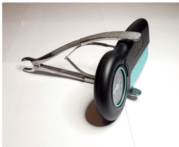
Рис. 1. Загальний вигляд виготовлених авторами щипців для моделювання перелому нижньої щелепи
