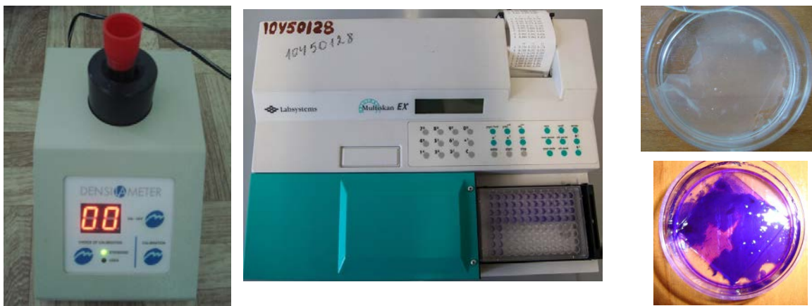
Рисунок 2.1. Мутномер «Densi-La-Meter», фотометр «Multiskan EX 355», нативна та забарвлена генціанвіолетом біоплівка в чашках Петрі (якісний метод) та в планшетах (кількісний метод).
