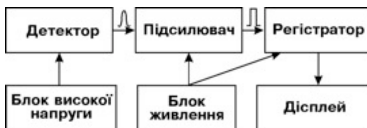
Рисунок 1.10. Принципова схема будови радіаційного дозиметра
