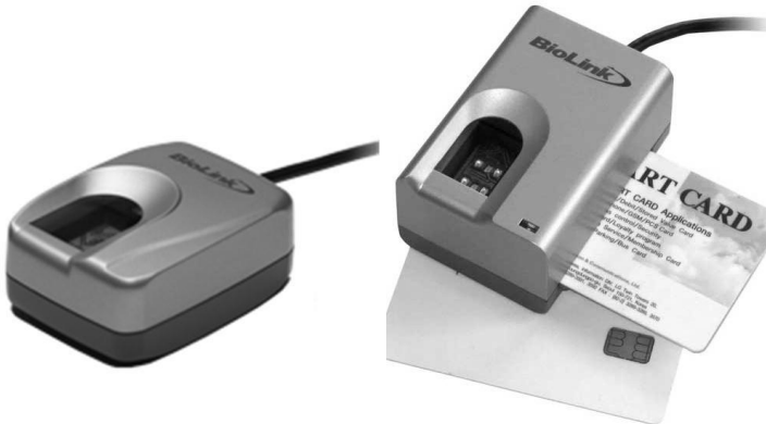
Рис. 3.4. Сканери BioLink, які дозволяють виробляти біометричну аутентифікацію за відбитком пальця (зліва) і комбіновану, що доповнює використання смарт-карт (праворуч)
