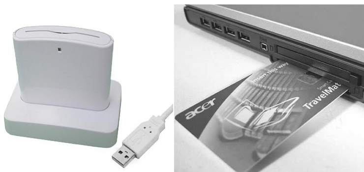
Рис. 3.2. Контактні зчитувальні пристрої для смарт-карт, що підключаються через порт USB (зліва) або у відповідний слот ноутбука (праворуч)
