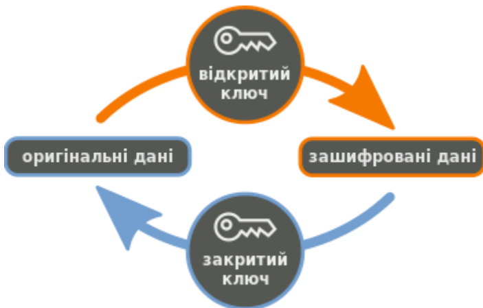
Рис. 3.7. Схема асиметричного шифрування з відкритим ключем
