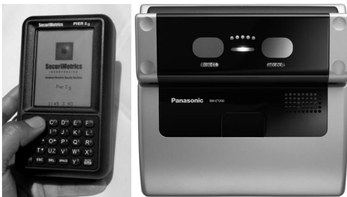
Рис. 3.6. Ручний (зліва) і стаціонарний (праворуч) сканери райдужної оболонки ока
