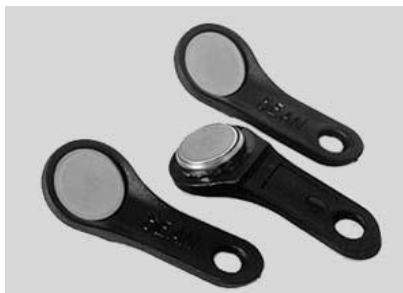
Рис. 3.3. iButton – сімейство мікроелектронних пристроїв, розроблених фірмою Dallas Semiconductor (USA)
