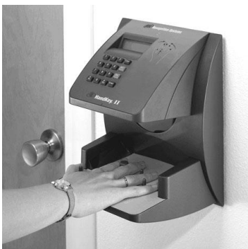
Рис. 3.5. Ідентифікація особистості за допомогою біометричного зчитувача HandKey II
