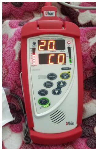
Рис. 2. Прилад Masimo Rad-57, що показує зростання в крові вмісту \text{COHb} (20%) в результаті гемолізу, що відбувся у пацієнта з травмою (власне спостереження)
