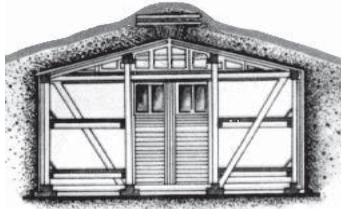
Рис. 6.1.4. Землянка з елементів збірного типу
