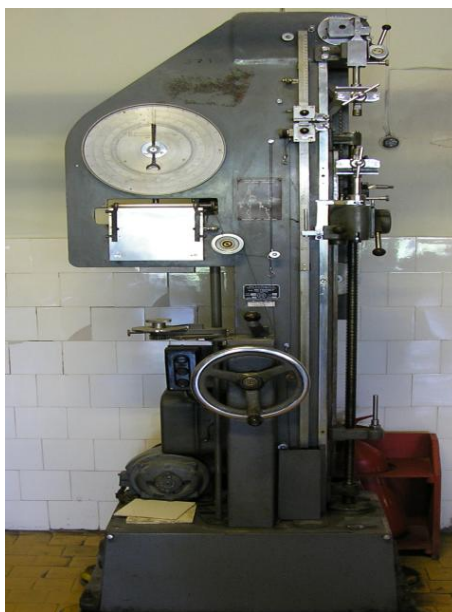
Рис. 2.2 Апарат «РММ-250» для визначення міцності зв'язку А-силіконового матеріалу з акриловим базисом протеза
