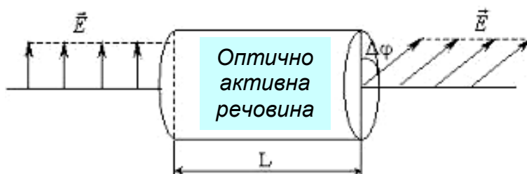
Рис. 3.44. Поворот площин поляризації світла оптично активною речовиною
