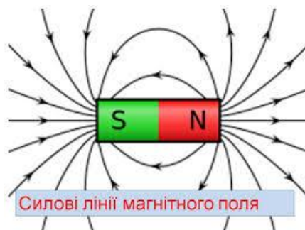
Рис. 2.14. Ілюстрація силових ліній магнітного поля
