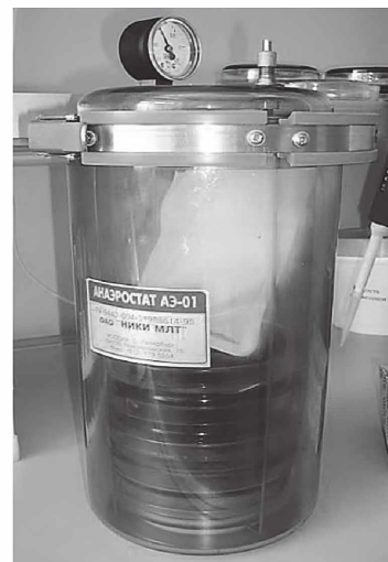
Рис. 1. а) Транспортні середовища після забору матеріалу з вивчаємих біотопів; б) інкубація досліджуваного матеріалу в умовах мікроаеростату «АЕ-01».
