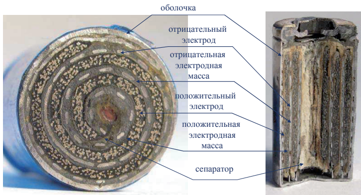
Рис. 4 Строение никель-кадмиевого аккумулятора.
