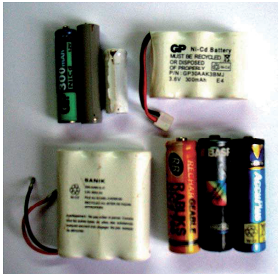
Рис. 3. Основные виды никель-кадмиевых аккумуляторов, представленных на украинском рынке
