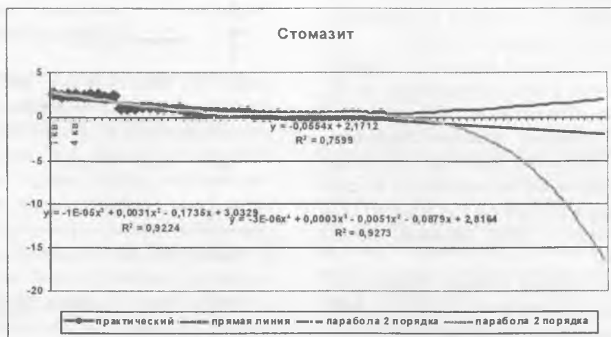
Рис. 4. Математическое моделирование диффузии ионов фтора из ФКМ «Stomazit LC»
