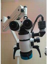
Прибор имеет встроенный 6-ти шаговый переключатель коэффициента увеличения (табл. 1,2), может иметь напольное, настенное, потолочное крепление; комплектуется дополнительными аксессуарами, такими как цифровая камера для фото и видеосъемки, УФ фильтр и др.
