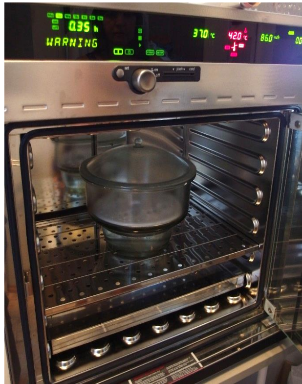
Рисунок 1. Чашки Петрі зі зразками імплантатів на фільтрувальному папері, просоченому розчином, що імітує слину. Ексикатор зі зразками імплантатів у чашках Петрі та його розташування у термостаті.
