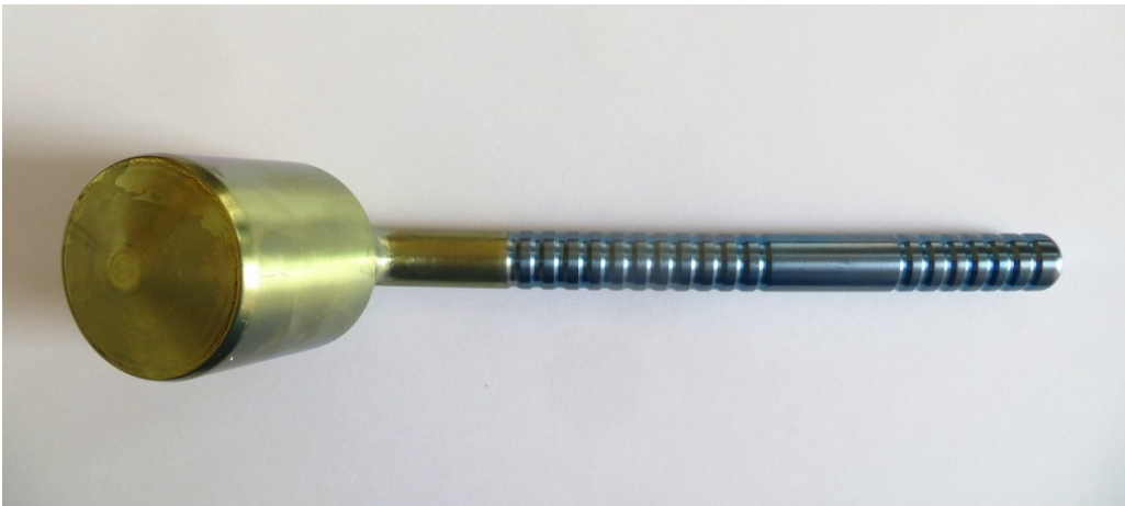
Рис. 8.20 Інструмент магнітний пошуковий: а – вид збоку; б – вид зверху. 1 – ручка інструмента, 2 – робоча магнітна частина
