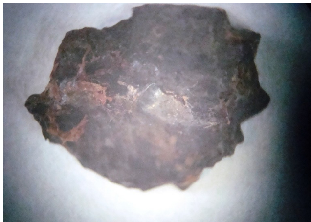
Рис. 9.60 Наявність окалини на металевому осколку, яке свідчить про температурний вплив на СТ, видима мікроскопічно при збільшенні \times 100
