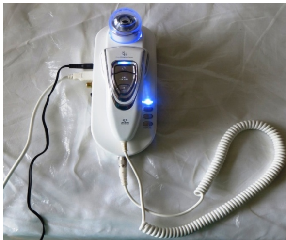
Рис. 6.11 Оптико-діагностичний пристрій «Green Light» з програмним забезпеченням і насадкою 60×
