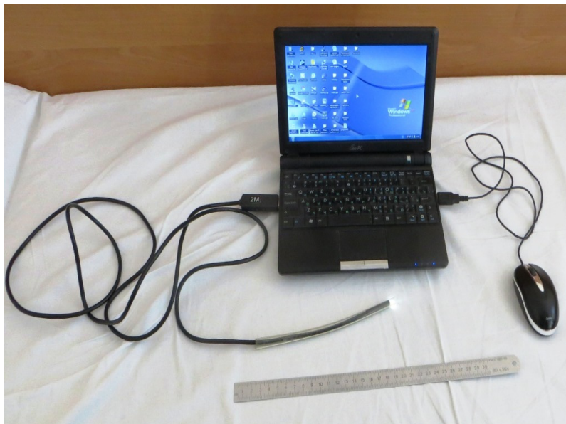
Рис. 6.4 Зовнішній вигляд USB 2,0 Endoscope camera з нетбуком ASUS
