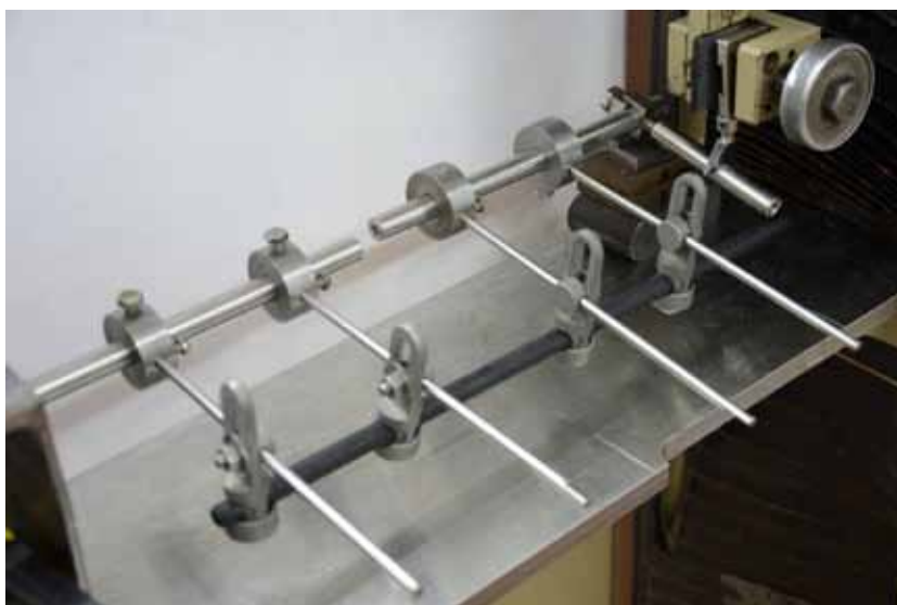
Рис. 8.58 Система «апарат — ушкоджена довга кістка» (в якості кістки були використані сталеві стержні) при випробуванні її на кручення
