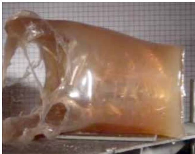
Рис. 2.23 Вигляд желатинового блоку після пострілу кулею типу «Б-32», калібр 12,7 мм
