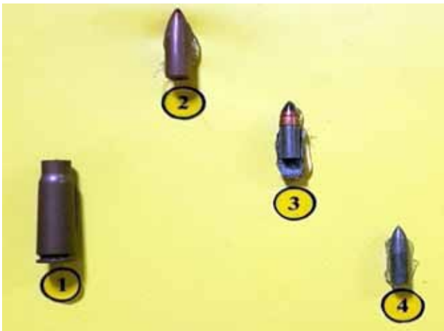
Рис. 2.14 Патрон калібру 7,62х39 мм (автомат АКМ): гільза «гс» (1), куля типу «БЗ» (2), куля в розтині (3), сталеве осереддя (4)
