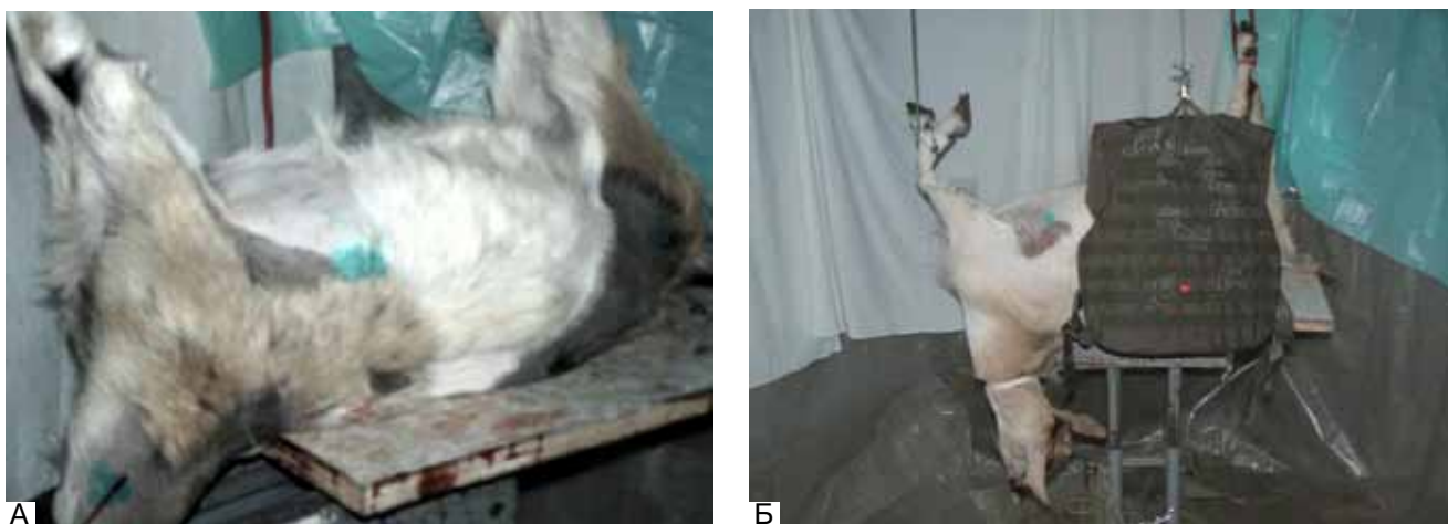
Рис. 1.18 Випробування вогнепальної зброї. А. На відкриті ділянки тіла. Б. При застосуванні ЗІЗ (бронежилету 4 класу)
