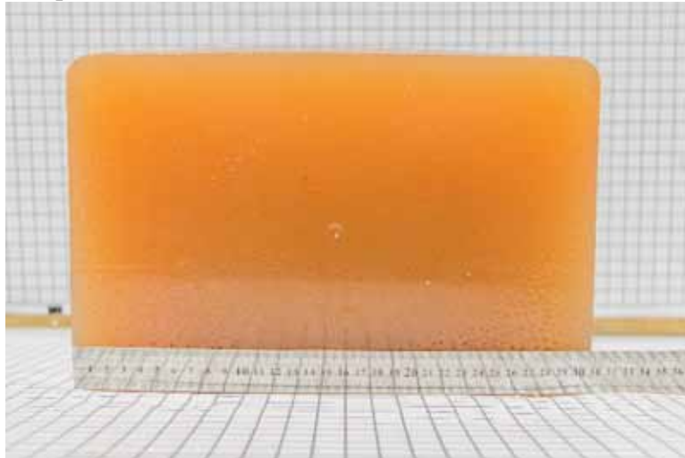
Рис. 2.1. Балістичний блок з 20 % желатину
