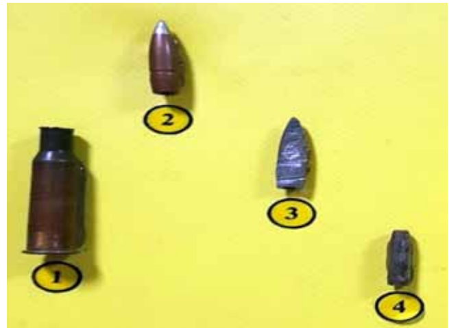
Рис. 2.15 Патрон калібру 7,62х54R мм (гвинтівка СВД): гільза «гс» (1), куля типу «ЛПС» (2), куля в розтині (3), сталеве осереддя (4)
