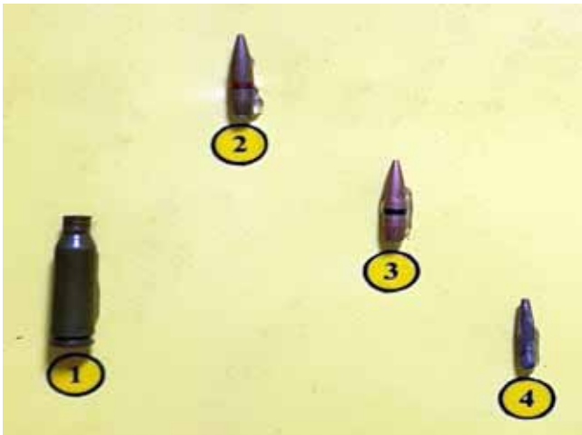
Рис. 2.13 Патрон калібру 5,45х39 мм (автомат АК-74): гільза «гс» (1), куля типу «ПС» (2), куля типу «ПП» (3), сталеве осереддя (4)
