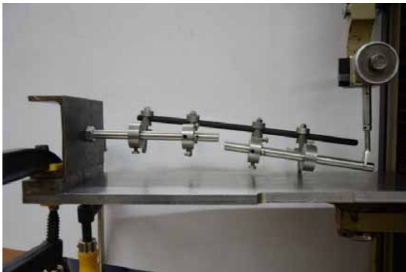
Рис. 8.57 Система «апарат — ушкоджена довга кістка» (в якості кістки були використані сталеві стержні) при випробуванні на згин поперек площини гвинтів Шанца
