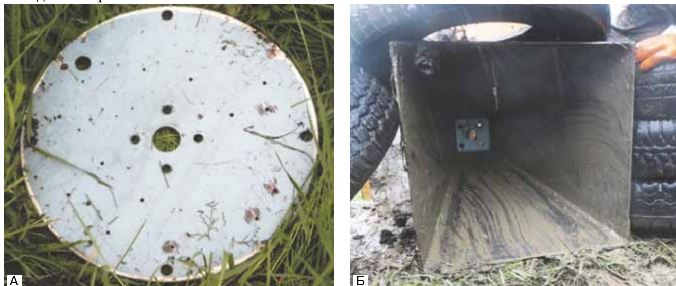
Рис. 5.4 Пристрій для моделювання вогнепальної травми: а — зовнішній вигляд диска-фільтра; б — зовнішній вигляд зібраної моделі для моделювання вогнепальної травми
