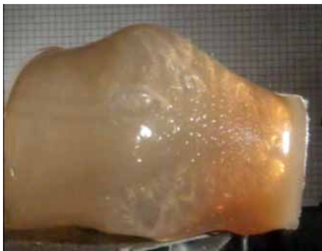
Рис. 2.24 Вигляд желатинового блоку після пострілу кулею типу «БЗТ», калібр 12,7 мм, початок формування ТПП
