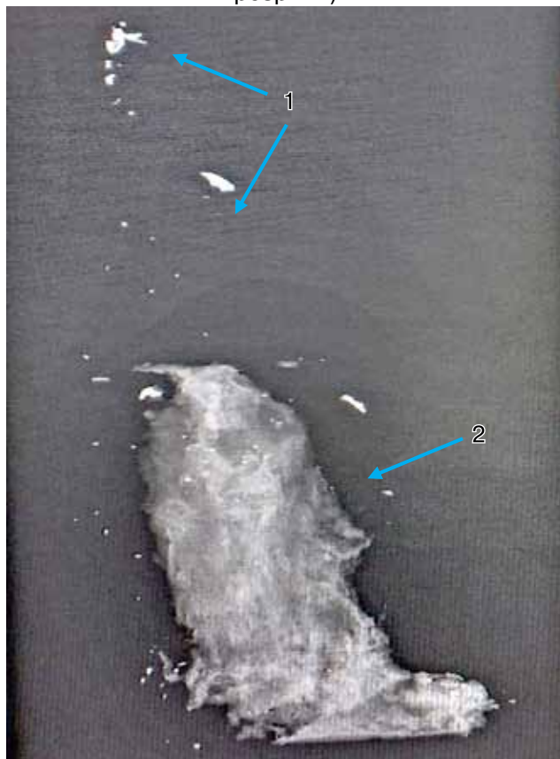
Рис. 3.23 Рентгенограма пластикової форми пострілу кулі 7,62x39 мм SP, (1 — металеві осколки, 2 — вхідний отвір)
