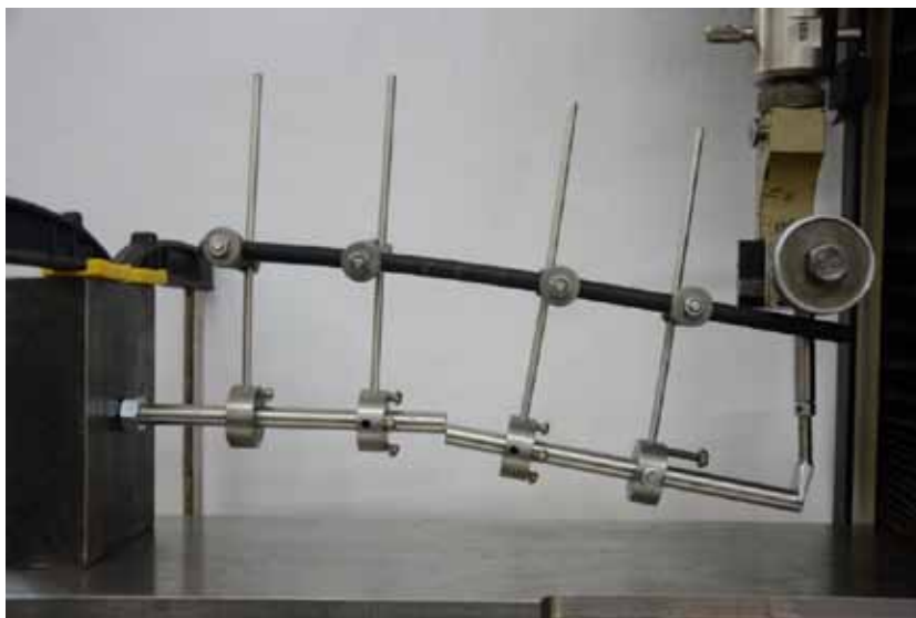
Рис. 8.56 Система «апарат — ушкоджена довга кістка» (в якості кістки були використані сталеві стержні) при випробуванні на згин вздовж площини гвинтів Шанца
