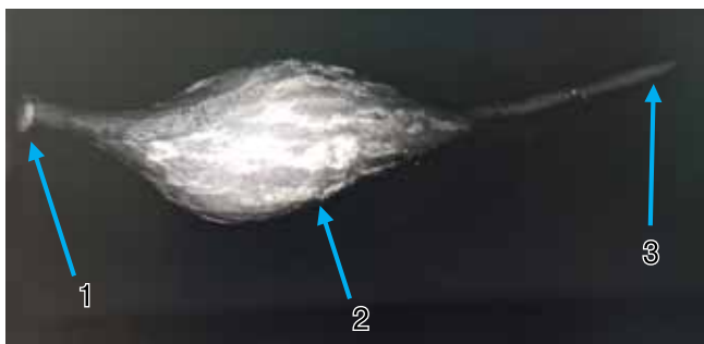
Рис. 3.17 Рентгенограма пластикової форми пострілу кулі 5,45x39 ПС (1 — вхідний отвір, 2 — тимчасово пульсуюча порожнина, 3 — вихідний отвір)
