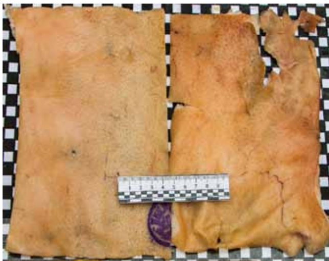
Рис. 2.28 Зовнішній вигляд та розміри вхідного та вихідного отворів на шкірно-жировому клапті свині після пострілу з автомату АКМ калібру 7,62 мм
