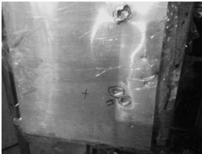
Рис. 1.50 Відбитки на листі сплаву алюмінію осколків після пробиття броньового захисту товщиною 10,5 мм кулею 7,62×54R Б-32
