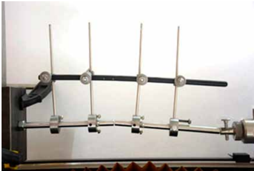
Рис. 8.55 Система «апарат — ушкоджена довга кістка» (в якості кістки були використані сталеві стержні) при випробуванні на компресійне навантаження
