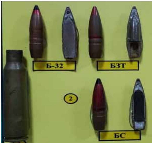
Рис. 1.27 Патрон калібру 12,7×108 мм (кулемет НСВТ): гільза «гс» (1), куля типу «Б-32», «БЗТ», «БС» та в розтині (2)
