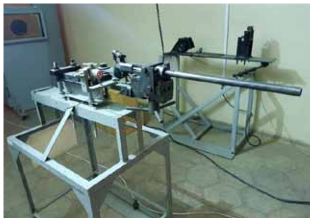
Рис. 1.19 Пристрій балістичний ПБ-53 № Я-021 Д. Балістичний ствол 5,45 мм
