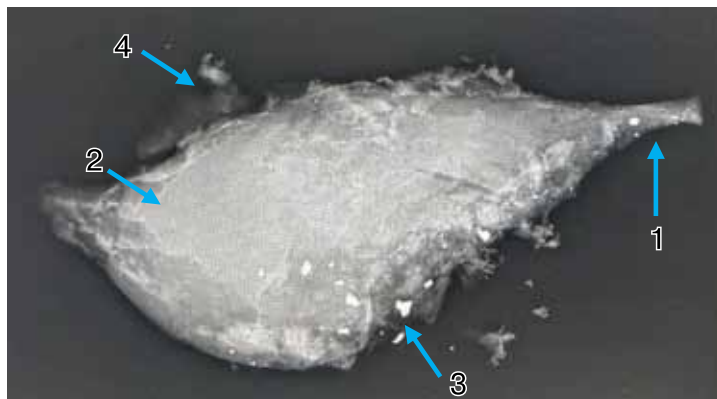
Рис. 3.20 Рентгенограма пластикової форми пострілу кулі 7,62x39 мм, (1 — вхідний отвір, 2 — тимчасово пульсуюча порожнина, 3 — металеві осколки, 4 — радіарні розриви)
