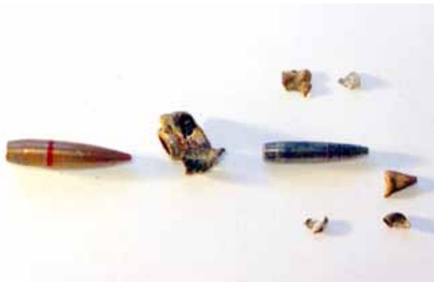
Рис. 2.27 Фрагментація кулі калібру 5,45 мм в желатиновому блоці
