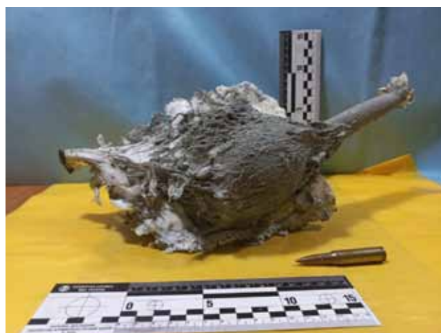
Рис.3.14 Пластикова форма при пострілі кулі калібру 7,62x39 мм
