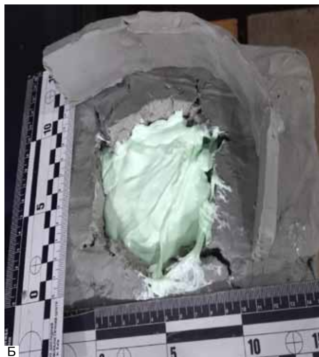
Рис. 3.5 Вхідний отвір (а) з заливкою форми (б) рідким пластиком
