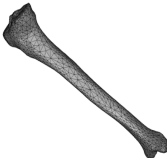
Рис. 8.13 3D-модель великогомілкової кістки, зі створеною скінченно-елементною сіткою тетраїдних елементів
