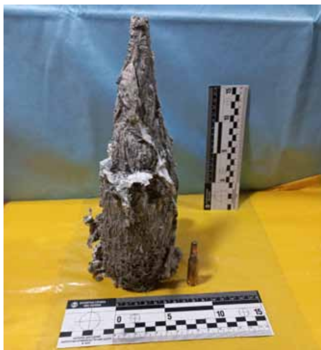
Рис. 3.15 Пластикова форма при пострілі кулі калібру 7,62x39 мм типу SP
