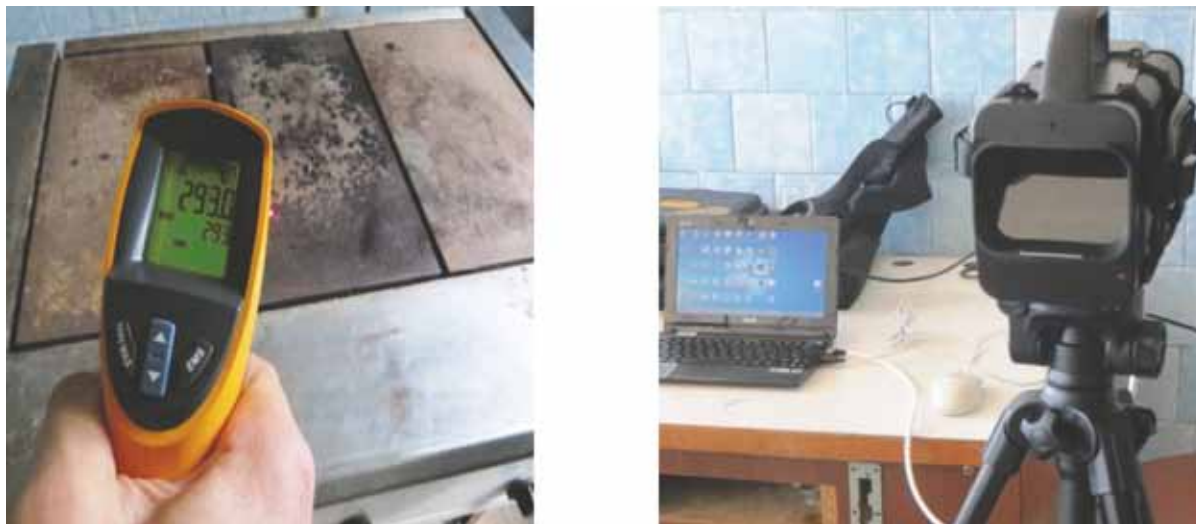
Рис. 5.10 Прилади для тепловізійних вимірювань: а — контроль температури осколка на поверхні кухонної плити за допомогою тепловізора Fluke Ti125; б — настройка термографа IPTIC 200 °С
