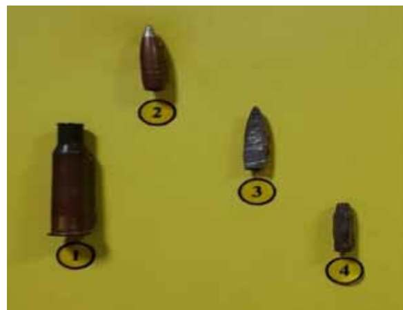
Рис. 1.26 Патрон калібру 7,62×54R мм (гвинтівка СГД): гільза «гс» (1), куля типу «ЛПС» (2), куля в розтині (3), сталеве осерддя (4)
