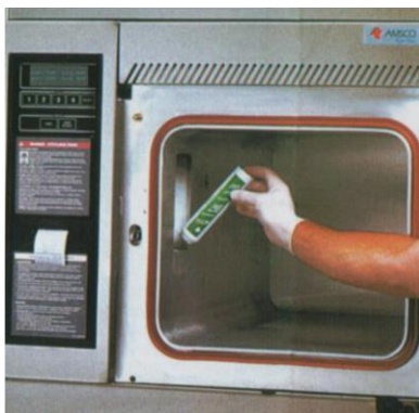
Рис. IX.5.3.2.1.1. Низькотемпературний стерилізатор-аератор AMSCO Eagle 3017 http://www.surgiplast.com.co/pdf_surgiplast/amsc0_eagle_3017.pdf
