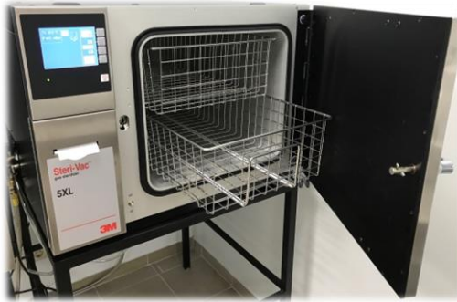
Рис. 5.3.2.1.2. Стерилізатор «Steri-Vac» низькотемпературний етиленоксидний https://medilife.com.ua/sterilizator-1.html
