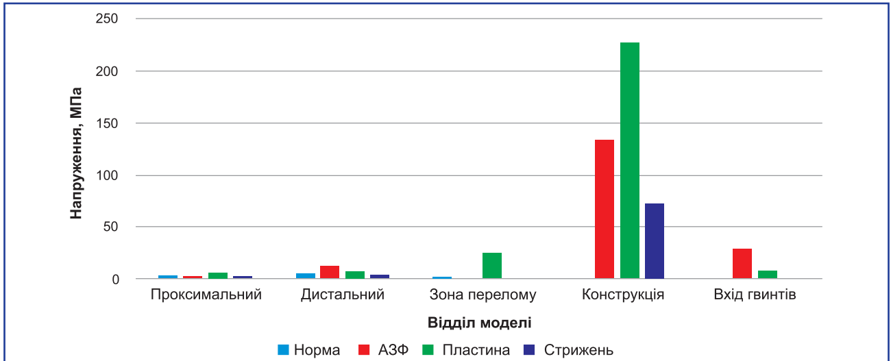
Рисунок 8. Діаграма величин максимальних напружень в елементах моделей голімки з переломом великогомілкової кістки при різних варіантах остеосинтезу під стискаючим навантаженням величиною 700 Н
