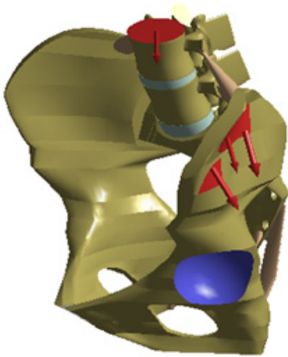
Рис. 2. Схема навантаження й закріплення моделі: червоним кольором подано прикладене навантаження і м'язові зусилля, синім – ділянка закріплення
