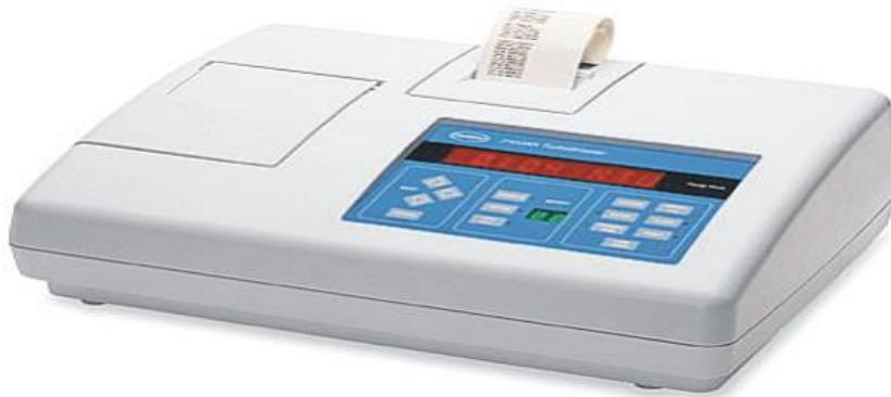
1. Флуктаціонний метод – заснований на аналізі флюктуацій світлопропускання, викликаних випадковим зміною числа частинок в оптичному каналі.
