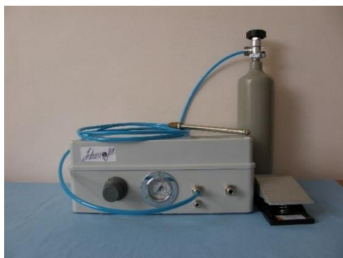
Мал.15. Зовнішній вигляд пристрою для газоструменевої дисекції печінки «Pneumojet»
