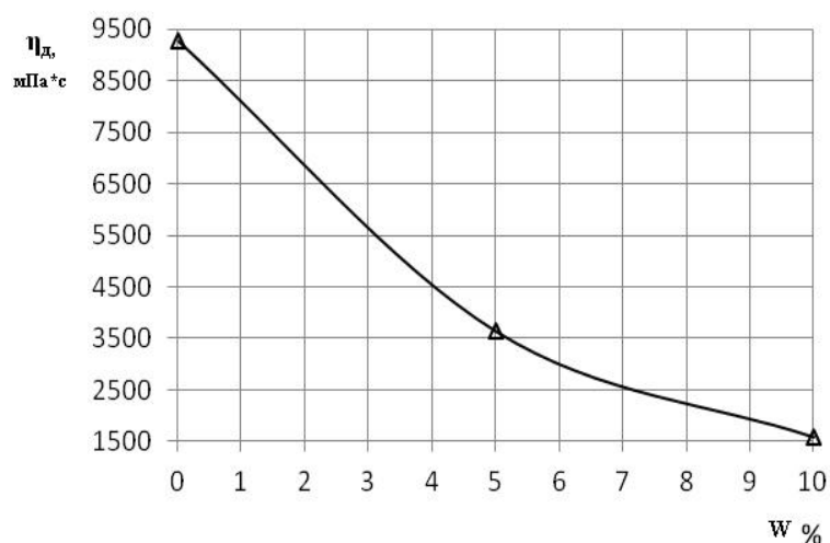
Рис. 1. Концентраційна залежність суміші Epoxy Resin LE-828/Diluent EGE CAS при температурі 298 К.
